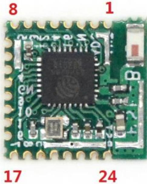
图 3 模块引脚顶视排列图
