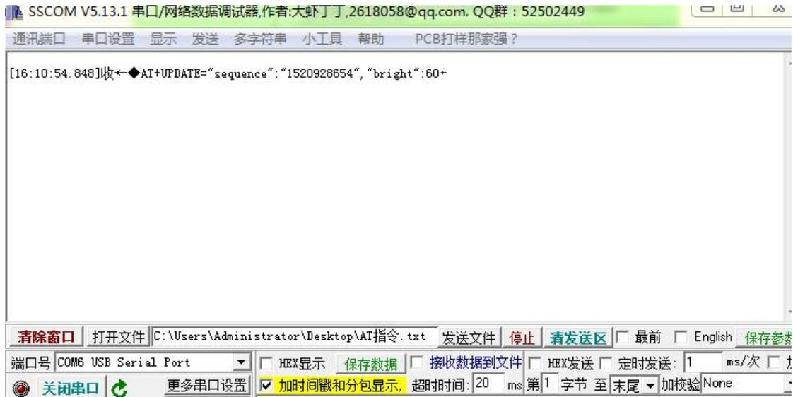
Web 调试工具端下发的指令跟 APP 端操作下发的指令相同，MCU 端只要及时回复该指令即可。
