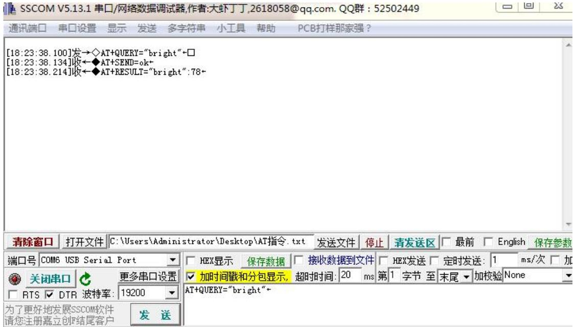
TA 模块首先回复“AT+SEND=ok”，表示 TA 模块已将 MCU 端发送的查询指令发送给服务器，再回复“AT+RESULT="bright":78”，表示当前 wifi 灯的亮度等级为 78（调试指令 2 中设置过）。
