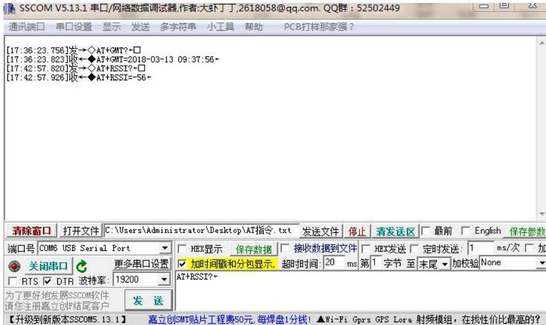
TA 模块回复的指令为“AT+RSSI=-56”，表示当前 TA 模块的 wifi 信号强度为-56dbm，此数值越接近 0，表示信号强度越好。
