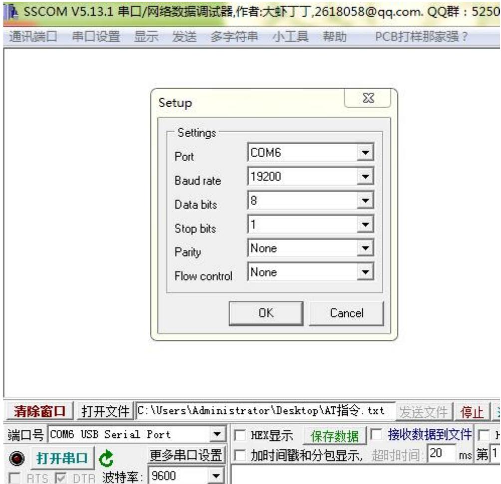
步骤二：在上述界面中的 Port 选项中选择自己电脑上正在使用的串口号，Baud rate（波特率）选项中选择 19200，Data bits（数据位）选项中选择 8，Stop bits（停止位）选项中选择 1，Parity（校验位）和 Flow control（流控）选项中都选择 None。选择完成后点击“OK”完成串口设置。
