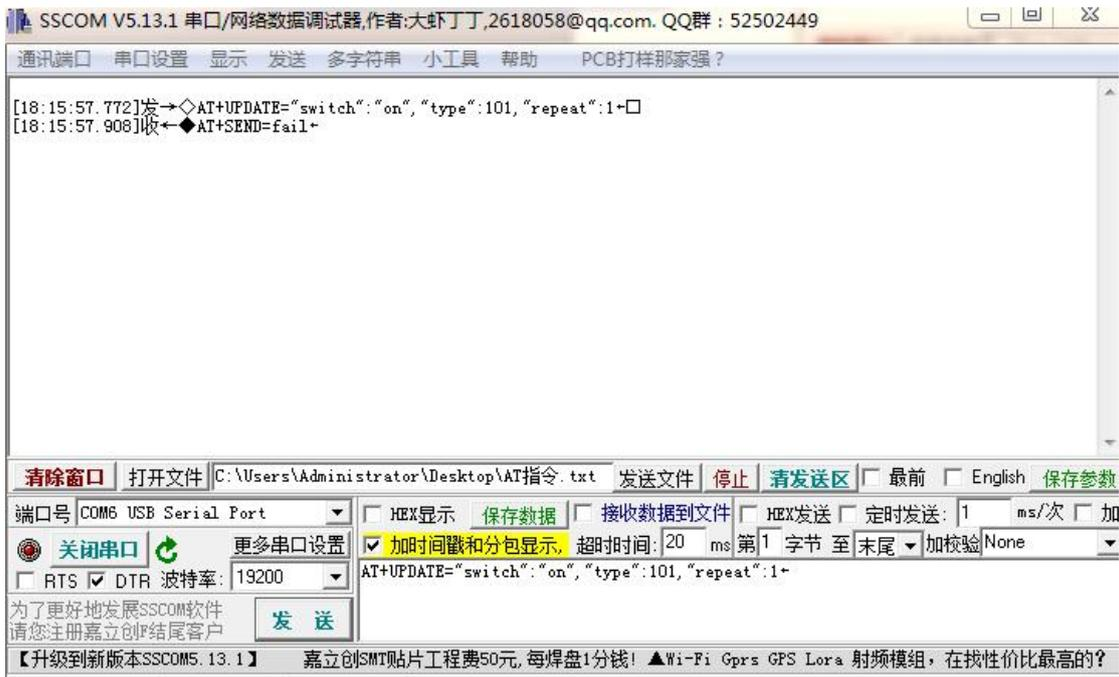
此时 TA 模块回复的指令为“AT+SEND=fail”，表示 TA 模块没有把打开 WIFI 灯的指令发送给服务器，出现此种情况的原因可能是 TA 模块没有连上网络或者没有被添加到 APP，此时在串口调试工具上发送“AT+STATUS?”这条指令判断 TA 模块的工作状态，获取 TA 模块的工作状态后再进行下一步判断。如下图所示：
